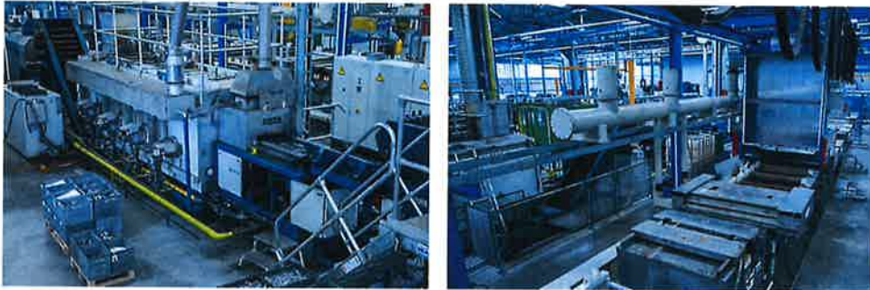
Produktionshalle Sindelfingen mit Durchlaufhärteanlage und Phosphatier-/Brünieranlage
