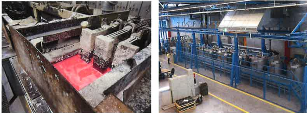
Offenes Salzhärtebad und neue Tiegelhärteanlage mit Badabdeckungen
