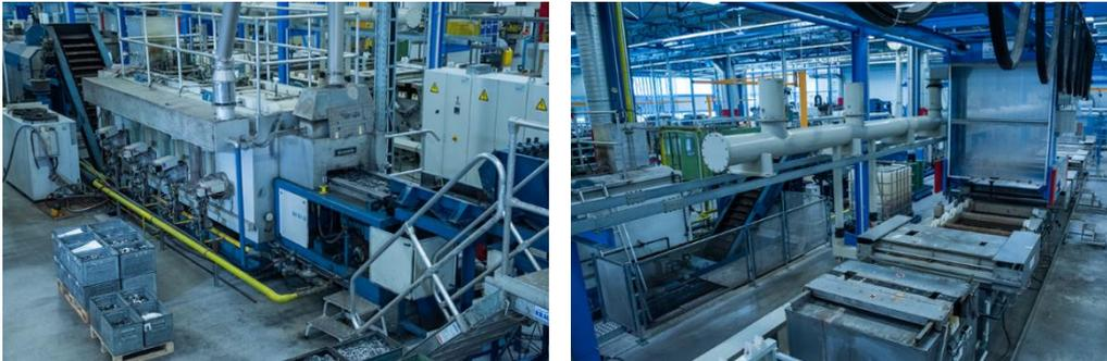
*Produktionshalle Sindelfingen mit Durchlaufhärteanlage und Phosphatier-/Brünieranlage*
