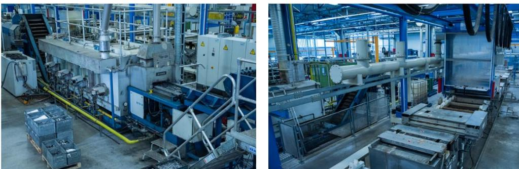
*Produktionshalle Sindelfingen mit Durchlaufhärteanlage und Phosphatier-/Brünieranlage*
